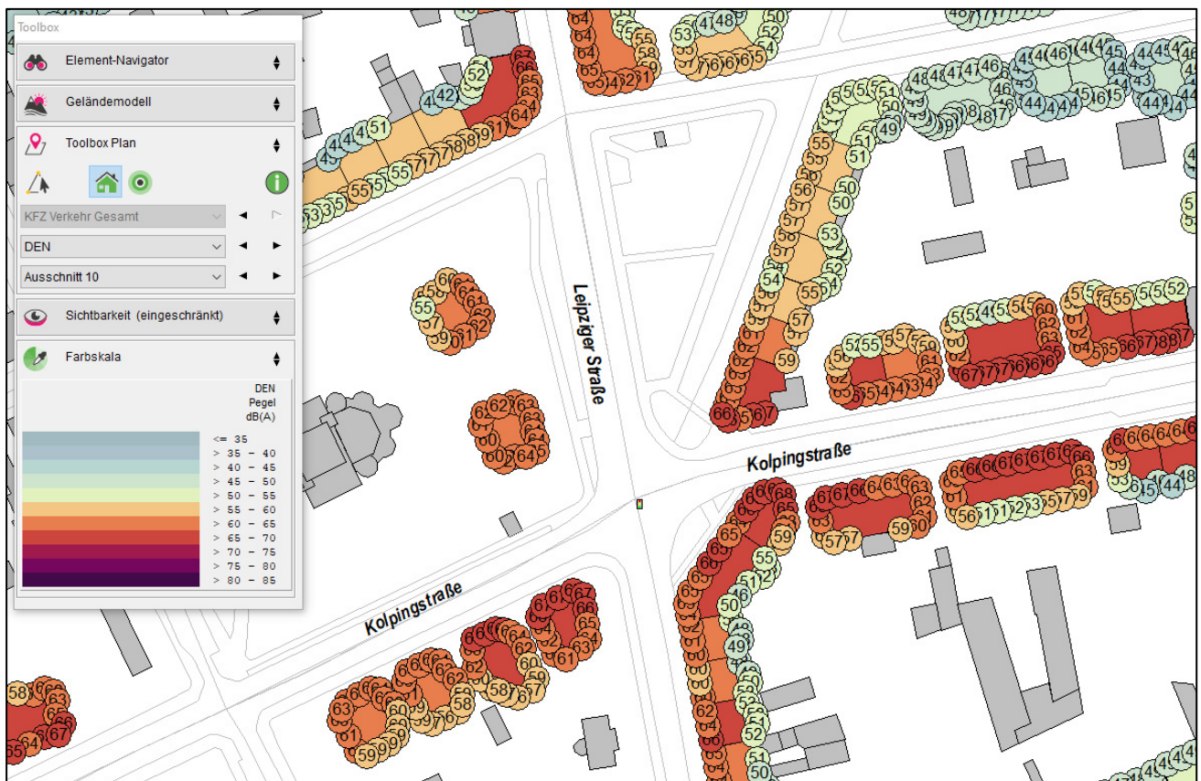
Abb. 5: Straßen-Verkehrslärm, Haus-Fassadenpegel an einzelnen Immissionspunkten bewohnter Gebäude gemäß BEB am Beispiel des Kreuzungsbereiches Kolpingstraße / Leipziger Straße
